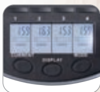
Mikroprozessor-gesteuertes Aufladen für 4 Akku-Schächte
