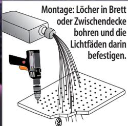
Montage: Löcher in Brett oder Zwischendecke bohren und die Lichtfasern darin befestigen.
