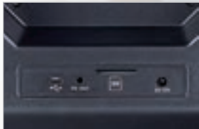
Anschlüsse auf der Rückseite: Mini-USB, TV-Out (3,5 mm Klinke), Steckplatz für SD(HC)-Karten bis 32 GB, Stromversorgung
